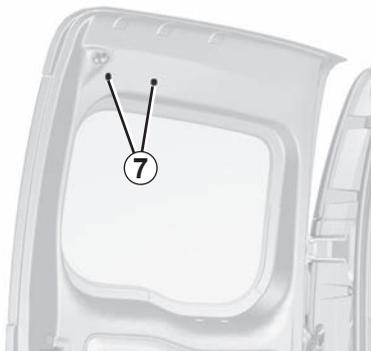
Dall'interno, rimuovete i due otturatori in plastica **7**. Sganciate la luce con un cacciavite premendo nell'alloggiamento delle graffe metalliche.
