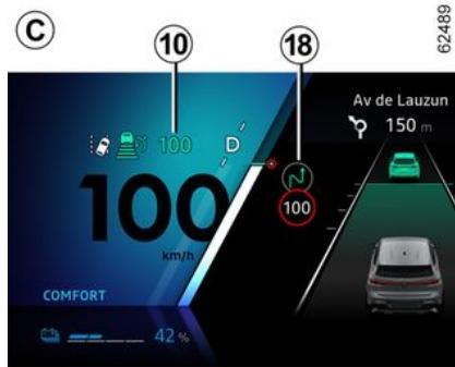
Utilizzando la telecamera, la funzione "Rilevamento segnaletica stradale" → 247 e la mappatura acquistata con l'abbonamento, il sistema può anticipare e gestire l'adattamento automatico della velocità di crociera **10**, quando il veicolo si avvicina a una rotondella o a una curva.
