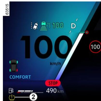
Questo sistema rileva una perdita di pressione in uno degli pneumatici misurando la velocità delle ruote durante la guida.
