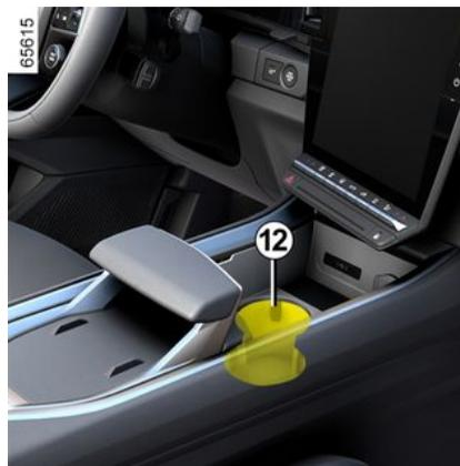
A seconda della versione del veicolo, il portabicchieri 12 può essere dotato di ganci di fissaggio per tenere i bicchieri in posizione.
