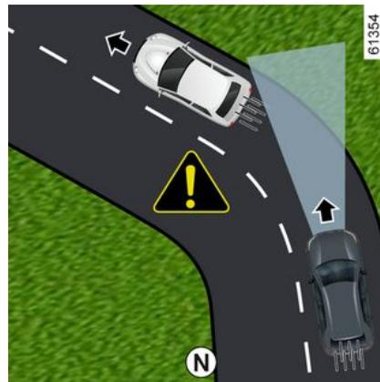
Quando ci si immette in una curva o in un angolo, la telecamera e/o il radar non saranno temporaneamente in grado di rilevare il veicolo che precede (ad esempio, **N**).
