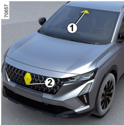
Con le informazioni della telecamera **1** e del radar **2**, il sistema determina la distanza del proprio veicolo:
