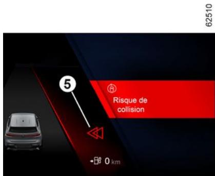
Durante la guida a una velocità compresa tra circa 65 km/h e 110 km/h, se sussiste un rischio di collisione con
