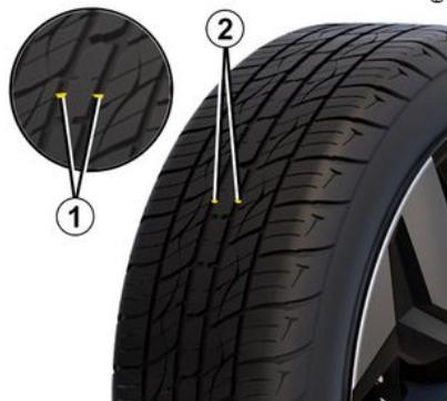
Quando il battistrada degli pneumatici è usurato fino al livello dei relativi indicatori di usura, **questi ultimi diventano visibili 2: sarà quindi necessario sostituire gli pneumatici in quanto la profondità della gomma del battistrada è al massimo di 1,6 mm, con conseguente rischio di scarsa tenuta di strada sul bagnato**.
