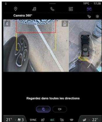
Se viene rilevato un ostacolo in prossimità della parte anteriore o posteriore del veicolo, la funzione "Zoom auto" commuta la visualizzazione corrente in una specifica (vista dall'alto, frontale o posteriore).
