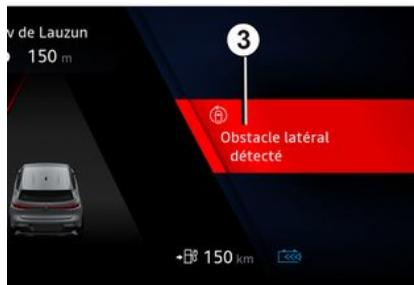
Quando l'oggetto rilevato è molto vicino, viene emesso un segnale acustico insieme al messaggio di avviso "Ostacolo later. rilevato" **3** sul quadro della strumentazione.
