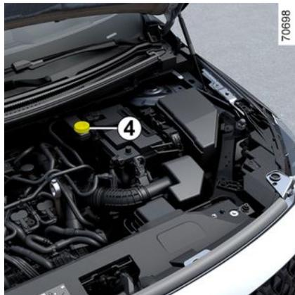
Deve essere controllato spesso e comunque ogni volta che si avverte una variazione anche minima nell'efficacia dell'impianto frenante. Il controllo del livello si esegue a motore fermo e su superficie orizzontale.
