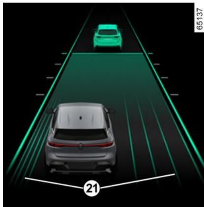
Per attivare la posizione in corsia, la funzione "Centraggio corsia" deve essere in modalità di regolazione, la spia verde **22** deve essere visualizzata sul quadro della strumentazione e la velocità del veicolo deve essere inferiore a 50 km/h.
