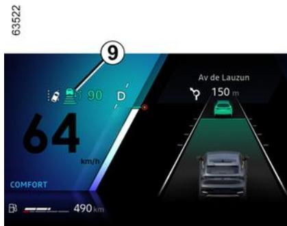
Il radar è in grado di rilevare i veicoli che precedono il vostro veicolo. Il sistema non può funzionare correttamente se l'area di rilevamento radar è oscurata o se il segnale è interrotto.
