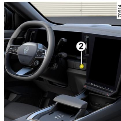
Se lo smartphone non si trova più nell'abitacolo quando si tenta di spegnere il motore, sul quadro della strumentazione viene visualizzato un messaggio: tenere premuto il pulsante di avviamento/spegnimento del motore **2** per più di due secondi.
