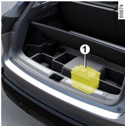
A seconda del veicolo, la batteria **1** si trova nel bagagliaio ➔ **22**.
