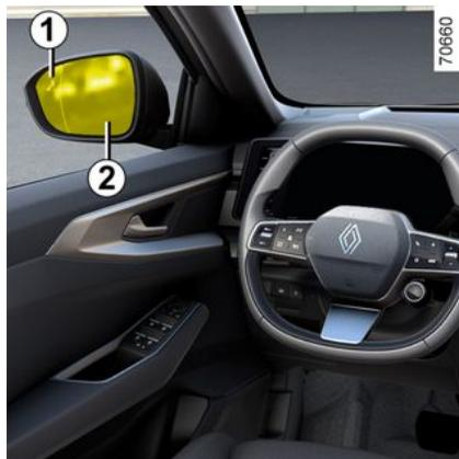
Quando viene aperta una portiera o quando viene rilevato un oggetto in movimento, la spia **1** viene visualizzata sullo specchietto retrovisore della portiera **2** e, a seconda del veicolo, si accendono le luci ambiente sulla portiera anteriore.
