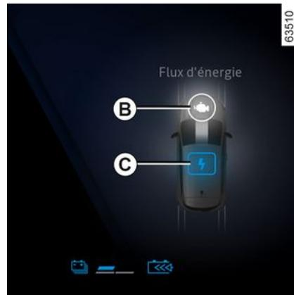
A seconda della modalità di guida selezionata, sul quadro della strumentazione vengono visualizzati i vari flussi energetici.
