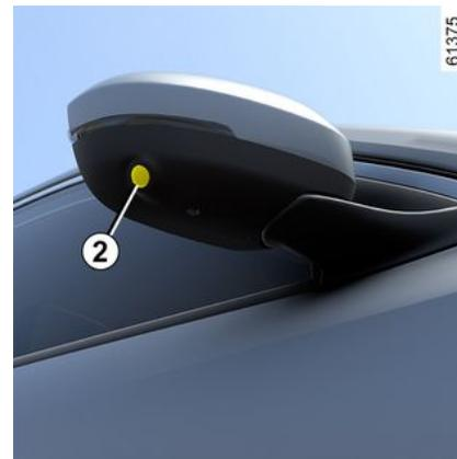
La telecamera 2, montata nello specchietto retrovisore esterno, trasmette una vista laterale sullo schermo multimediale 5.
