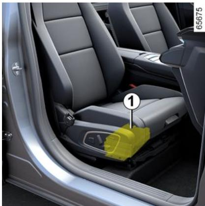
A seconda del veicolo, in un apposito vano sotto il sedile passeggero anteriore è presente una batteria secondaria **1** che fornisce l'energia necessaria per il funzionamento di alcuni sistemi.
