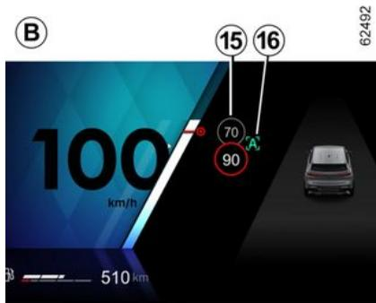
Il sistema, tramite la telecamera, la funzione "Rilevamento segnaletica stradale" ➔ 247 e la mappa associata all'abbonamento, anticipa la regolazione automatica della velocità del veicolo fino al successivo segnale **15**.
