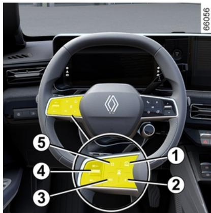
La funzione limitatore di velocità è messa in standby quando si preme il contattore **2** (0).
