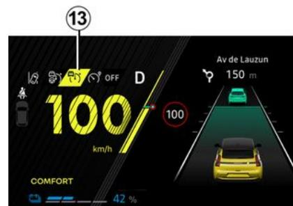
Premere il contattore **3** per selezionare il regolatore di velocità adattivo **13**. La spia **9** si accende il messaggio "Regolatore adattivo pronto SET per attivare" viene visualizzato sul quadro della strumentazione accompagnato da dei trattini per indicare che la funzione regolatore di velocità funziona e in attesa di memorizzare la velocità di regolazione.
