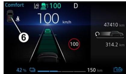
Con le porte chiuse, il simbolo **6** viene visualizzato sul quadro della strumentazione per circa 60 secondi all'inserimento dell'accensione del veicolo. Il conducente viene informato circa lo stato di allacciamento di ciascuna cintura di sicurezza anteriore:
