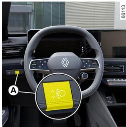
A seconda del veicolo, il contattore **A** può essere utilizzato per regolare l'altezza dei fasci dei fari in base al carico.
