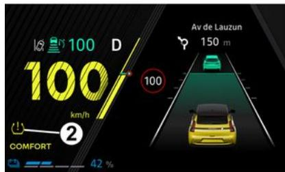
Questo sistema rileva una perdita di pressione in uno degli pneumatici misurando la velocità delle ruote durante la guida.
