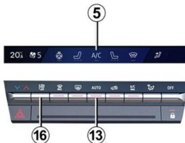
Il sistema agisce sulla velocità di ventilazione, ripartizione dell'aria, ricircolo dell'aria, attivazione o spegnimento dell'aria condizionata e temperatura dell'aria.
