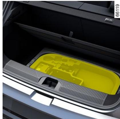
La cassetta degli attrezzi è sistemata sotto il tappetino del bagagliaio. Dopo l'utilizzo, abbiate cura di sistemare correttamente gli attrezzi.
