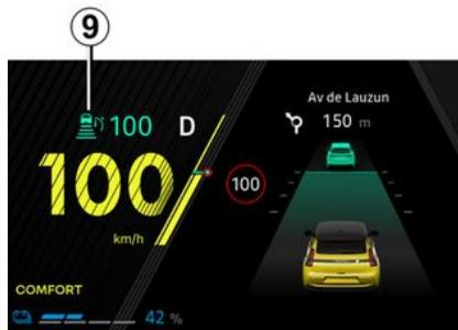
Il radar è in grado di rilevare i veicoli che precedono il vostro veicolo. Il sistema non può funzionare correttamente se l'area di rilevamento radar è oscurata o se il segnale è interrotto.
