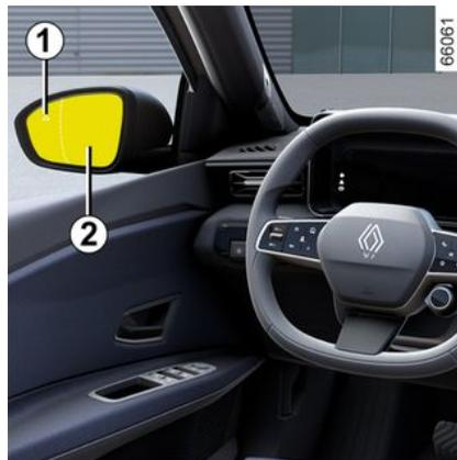
Quando viene aperta una porta e viene rilevato un oggetto in movimento, la spia **1** viene visualizzata sul retrovisore esterno **2** e, seconda del veicolo, si accendono le plafoniere sulla porta anteriore.
