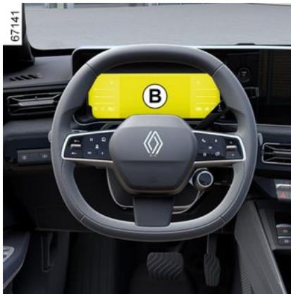
**Quadro della strumentazione A o B:** si accende quando si apre la porta del conducente. Per regolare la luminosità del cruscotto, consultare il libretto di istruzioni del sistema multimediale.
