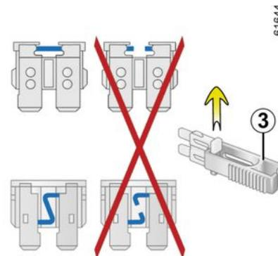
Rimuovere il fusibile utilizzando la pinza **3** situata sul pannello dei fusibili.
