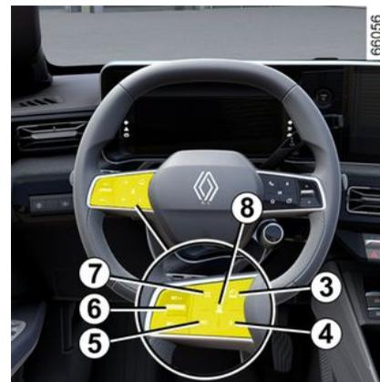
**3.** Contattore per selezionare/deselezionare i sistemi di assistenza alla guida, a seconda del veicolo:
