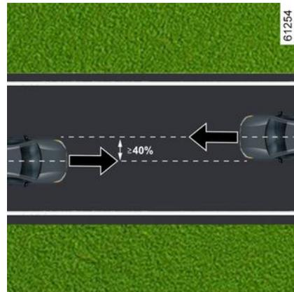
**In caso di impatto frontale con un altro veicolo di categoria equivalente o superiore, con area d'impatto uguale o superiore al 40%, in cui la velocità di entrambi i veicoli sia uguale a superiore a 40 km/h.**
