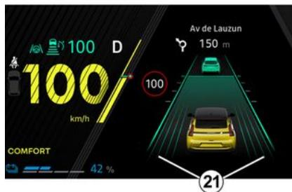
Per regolare la posizione nella corsia, la funzione "Centraggio corsia" deve essere in modalità di regolazione, la spia verde **22** deve essere visualizzata sul quadro della strumentazione e la velocità del veicolo deve essere inferiore a 50 km/h.
