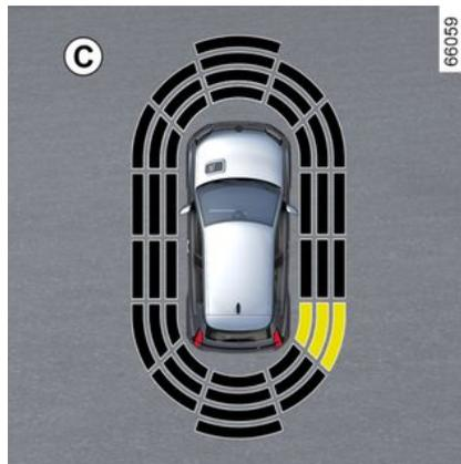
La maggior parte degli oggetti che si trova in prossimità della parte anteriore, della parte posteriore e dei lati del veicolo viene rilevata.
