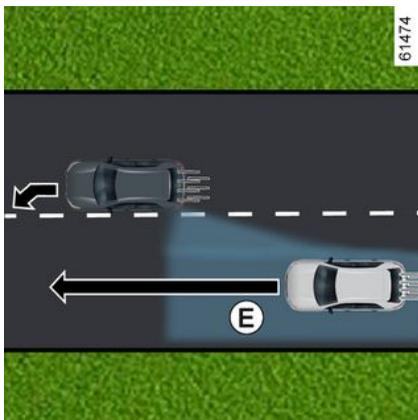
vi è il rischio di collisione con un veicolo presente nell'angolo morto **D** e si muove nella stessa direzione del proprio veicolo o con un veicolo che si avvicina rapidamente da dietro o in una corsia adiacente che si trova nell'area di rilevamento **E**, il sistema:
