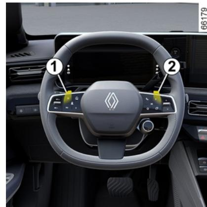
A seconda del veicolo, è possibile utilizzare le levette **1** e **2** per modificare il livello di frenata rigenerativa con la leva del cambio in posizione **D**:
