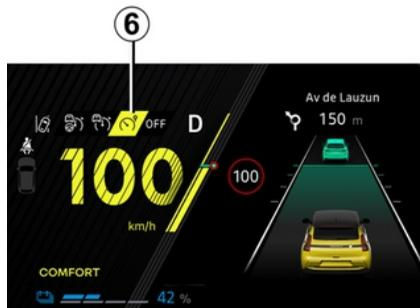
La funzione di limitatore della velocità viene interrotta quando si preme il contattore **1** per deseleggerlo. In tal caso la velocità non è più memorizzata.
