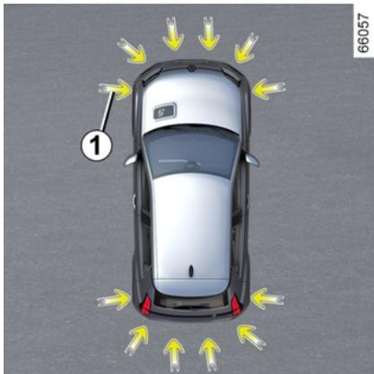
I sensori a ultrasuoni, indicati dalle frecce **1**, sono montati nei paraurti per rilevare gli ostacoli in prossimità del veicolo.
