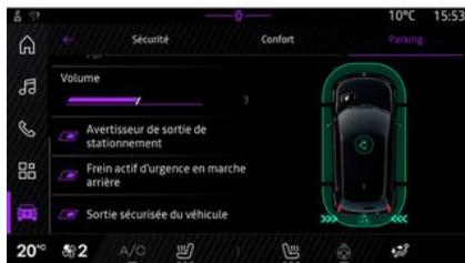
Per attivare o disattivare la funzione tramite lo schermo multimediale **1**, selezionare il mondo "Veicolo", quindi "Assistenza alla guida" e infine "Parcheggio". Attivare la "Frenata attiva di emergenza in retromarcia". Se la funzione è disattivata, sullo schermo multimediale viene visualizzata la spia **3**.
