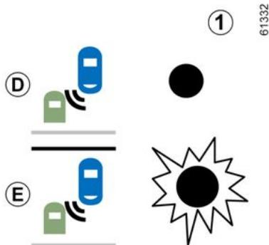
Prima avvertenza: **indicatore di direzione non attivato**, la spia **1** indica che un veicolo è stato rilevato nella zona dell'angolo morto e/o che un veicolo si avvicina rapidamente dalla parte posteriore in una corsia adiacente.
