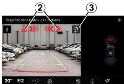
Se il veicolo è dotato di gancio di traino riconosciuto dal sistema ed è stato collegato un rimorchio, la frenata di emergenza attiva in retromarcia viene automaticamente disattivata e sul quadro della strumentazione viene visualizzato il messaggio "Rimorchio: sensori parcheggio indisponibili" insieme alla spia **3** sullo schermo multimediale.
