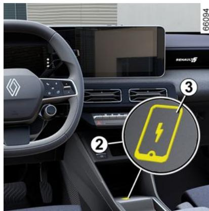
A seconda del veicolo, il simbolo 3 indica che l'area 2 può essere utilizzata per caricare il telefono senza bisogno di un cavo di ricarica.
