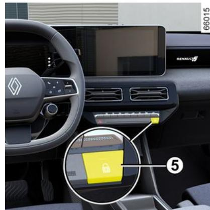
Il contattore **5** controlla contemporaneamente le porte e la porta del bagagliaio.
