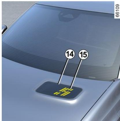
A seconda del veicolo, l'indicatore del livello di carica **14** sul cofano motore mostra lo stato di carica del veicolo.
