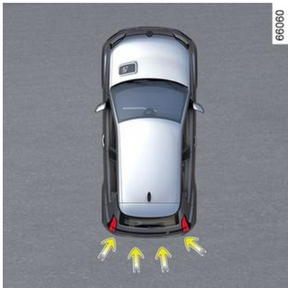
Oltre alla funzione "Assistenza al parcheggio" → 276 e utilizzando le informazioni dei quattro sensori centrali situati nella parte posteriore del veicolo, il sistema rileva gli ostacoli fissi che si trovano dietro al veicolo. Se c'è un rischio significativo di collisione, il sistema fa automaticamente frenare il veicolo.
