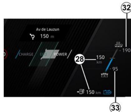
Alta **32**: visibilità dell'autonomia in condizioni ottimali (ad esempio, guida su strade secondarie o strade a doppia corsia con scarso utilizzo del comfort termico).
