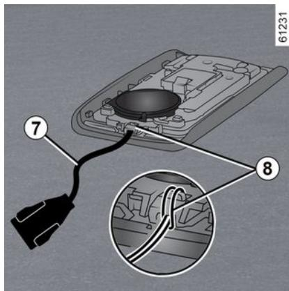
Inserire la cinghia nel componente **8** e fare passare l'estremità della cinghia manuale attraverso la fibbia. Posizionare la cinghia nell'apertura **6** e chiudere il guscio.
