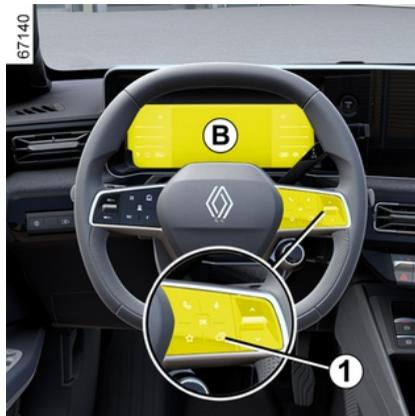
A seconda del veicolo, utilizzare il comando **1** per accedere e selezionare le varie viste sul quadro della strumentazione A o B.
