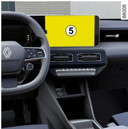
A seconda del veicolo, con l'accensione inserita è possibile attivare i sedili riscaldati tramite lo schermo multimediale **5**:
