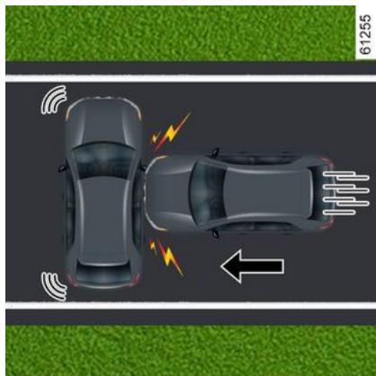
**In caso di urto laterale con un altro veicolo di categoria equivalente o superiore, ad una velocità d'impatto uguale o superiore a 50 km/h.**
