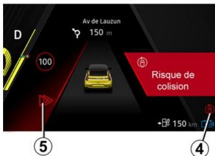
Durante la guida a una velocità compresa tra circa 65 km/h e 110 km/h, se sussiste un rischio di collisione con un veicolo proveniente dalla direzione opposta in una corsia adiacente e all'interno della zona di rilevamento **C**, senza che sia stato attivato l'indicatore di direzione, il sistema:
