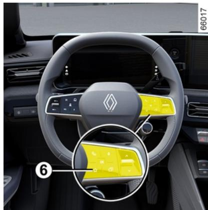
A seconda del veicolo, premendo il comando al volante **6** è possibile attivare i sedili riscaldati in base alle impostazioni di utilizzo dell'utente memorizzate e definite in precedenza.
