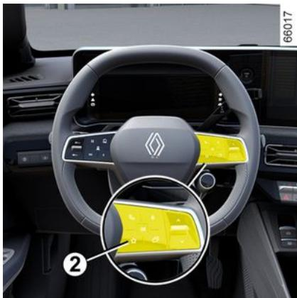
A seconda del veicolo, premendo il comando al volante **2** è possibile attivare le seguenti funzioni in base alle impostazioni utente memorizzate precedentemente definite:
