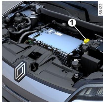
Il controllo del livello si esegue a motore fermo e su superficie orizzontale. Deve essere controllato spesso e comunque ogni volta che si avverte una variazione anche minima nell'efficacia dell'impianto frenante.
