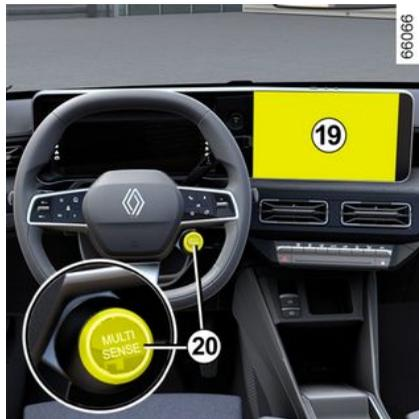
Dal menu MULTI-SENSE, accessibile dallo schermo multimediale **19** o premendo il contattore **20**, è possibile attivare la modalità ECO, che influisce sul livello di riscaldamento e riduce il consumo di carburante del veicolo.
