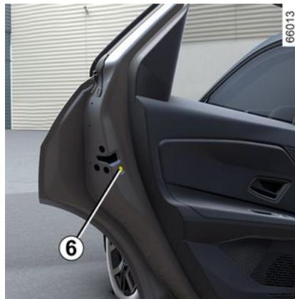
Per impedire l'apertura delle porte posteriori dall'interno, abbassare la levetta 6 e verificare dall'interno che le porte siano effettivamente chiuse.
