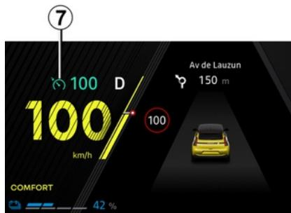
Premere il contattore **1** tutte le volte necessarie per selezionare il regolatore di velocità.
