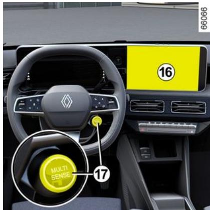
Dal menu MULTI-SENSE, accessibile dallo schermo multimediale **16** o premendo il contattore **17**, è possibile attivare la modalità ECO, che influisce sul livello di riscaldamento e riduce il consumo di carburante del veicolo.
