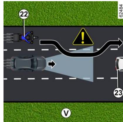
Se il veicolo viene superato da un altro veicolo che procede a velocità sostenuta **22** (motocicletta, auto e così via) e che si trova momentaneamente tra quello del conducente e quello che precede **23**, **il sistema potrebbe accelerare, rallentare o frenare in modo imprevisto.**
