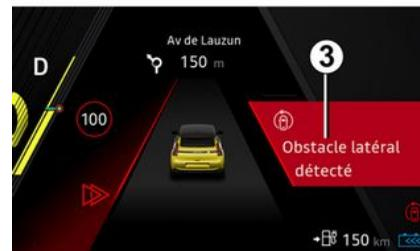
Quando l'oggetto rilevato è molto vicino, viene emesso un segnale acustico insieme al messaggio **3** "Ostacolo later. rilevato" sul quadro della strumentazione.
