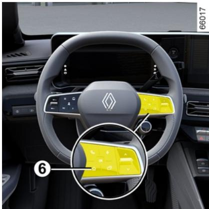
A seconda del veicolo, premendo il comando al volante **6** è possibile attivare il volante riscaldato in base alle impostazioni di utilizzo memorizzate precedentemente definite:
