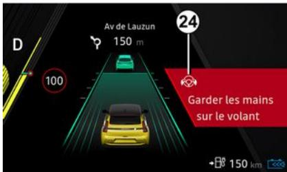
Quando la funzione "Centraggio corsia" non rileva più le mani sul volante, verranno attivati vari livelli di avviso:
