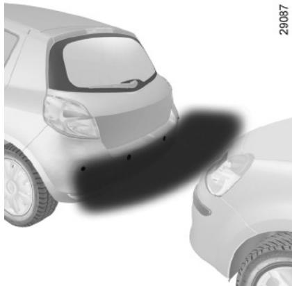
Quando il veicolo viaggia ad una velocità inferiore a 10 km/h, alcune fonti di rumorosità (moto, camion, martello pneumatico...) possono attivare dei segnali acustici.
