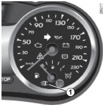
A seconda del veicolo, la spia
