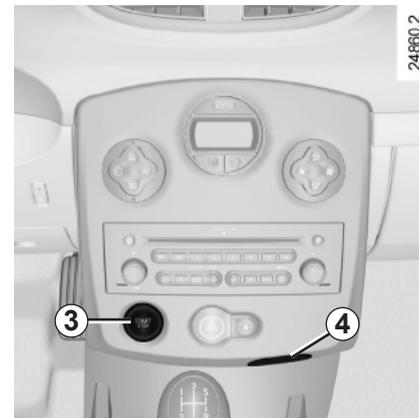
**Nota:** se il cambio non è in folle, l'indicazione lampeggia; l'avviamento è possibile soltanto mantenendo il pedale del freno premuto, la carta RENAULT nella zona di rilevamento **1** o nel lettore **4**.
