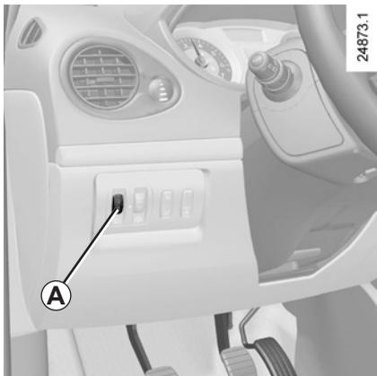
Per i veicoli che ne sono dotati, la rotella **A** permette di regolare l'altezza dei fari in funzione del carico.
