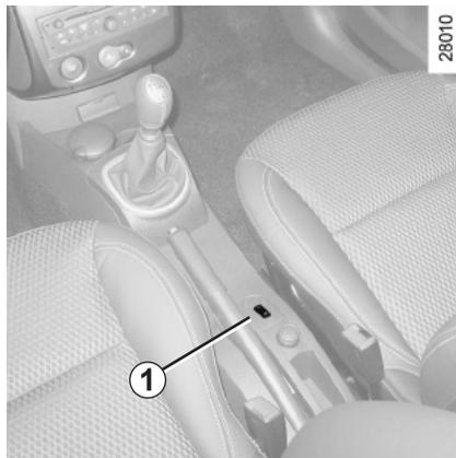
Il limitatore di velocità è una funzione che vi consente di non oltrepassare una determinata velocità di guida, da voi impostata.
