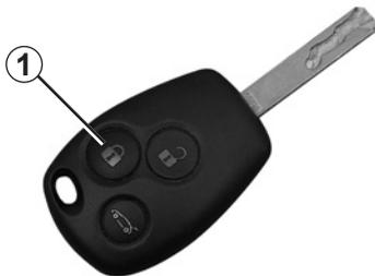
Se il veicolo ne è dotato, questa permette di bloccare le parti apribili e di impedire l'apertura delle porte dalle maniglie interne (in caso di rottura del vetro con tentativo d'apertura delle porte dall'interno).
