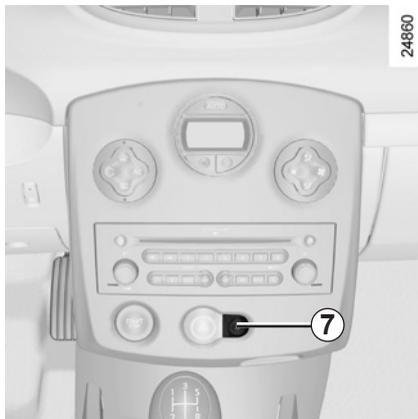
Per bloccare le serrature lasciando una parte apribile aperta (trasporto di oggetti con il bagagliaio aperto...), o quando il veicolo è situato in una zona caratterizzata da un'elevata presenza di onde elettromagnetiche, o in caso di guasto della chiave o della carta RENAULT: con contatto disinserito, premete per oltre cinque secondi il tasto **7**.
