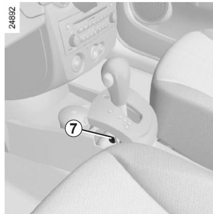
**All'attivazione**, se la leva è bloccata su **P** mentre schiacciate il pedale del freno, è possibile liberarla manualmente. Per fare ciò, sganciate la base della leva e premete contemporaneamente l'incavo **7**, visibile sul soffietto, e il tasto di sbloccaggio sulla leva.
